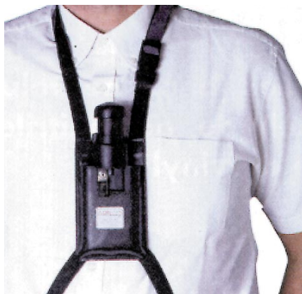
Prélèvement individuel omnidirectionnel avec le CIP 10
